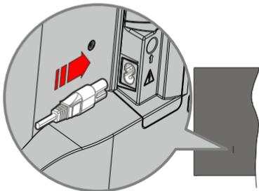
En konec (vtič z dvema odprtinama) priloženega odstranljivega električnega kabla vstavite v vhod napajalnega kabla na zadnji strani TV kot je prikazano zgoraj. Nato vstavite drug konec napajalnega kabla v električno vtičnico.
