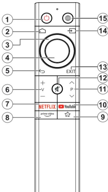
1. **Stanje Pripravljenosti(\*)**: Stanje pripravljenosti/vklop (kratek pritisk), ponastavitev/izklop (pritisnite in držite)
