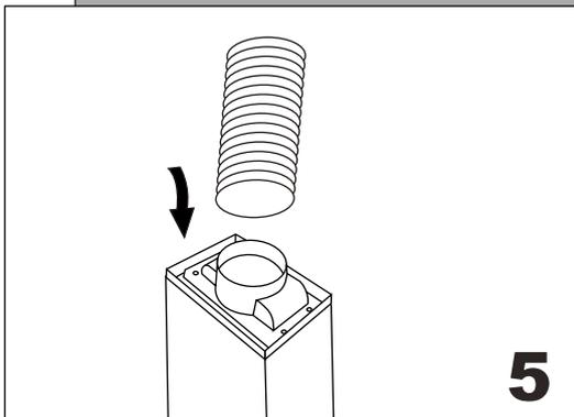
Schließen Sie den Schlauch am Luftkanal an.
