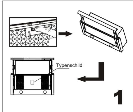
Überprüfen Sie die auf dem Typenschild an der Innenseite des Dunstabzuges angegebene Spannung und Frequenz.
