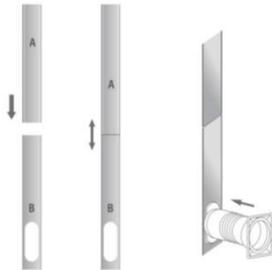
**Schritt 4:** Schließen Sie das Fenster, um den Satz zu sichern. Der Fensterschiebersatz muss festgehalten und ggf. mit Klebeband gesichert werden. Es wird empfohlen, den Spalt zwischen dem Adapter und der Seite des Fensters für maximale Effizienz abzudichten.
