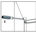
Setzen Sie die Kernabdeckung von links nach rechts um. Heben Sie die Tür nach oben heraus und stellen Sie sie auf einer weichen Unterlage ab, um sie nicht zu zerkratzen.
