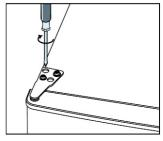
10. Setzen Sie die Scharnier- und Schraubenabdeckung zurück.
