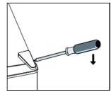
Lösen Sie die Schrauben. Dann entfernen Sie die Scharnierhalterung.
