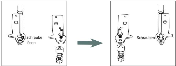
6. Montieren Sie den Halter, an dem der Stift für das untere Scharnier befestigt ist.. Ersetzen Sie den Nivellierfuß.
