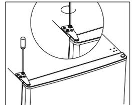
8. Bringen Sie die obere Abdeckung an und sichern Sie diese mit den 4 Schrauben an der Rückseite.
