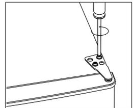
4. Schrauben Sie das untere Scharnier ab. Entfernen Sie dann den Nivellierfuß von der gegenüberliegenden Seite.
