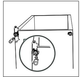
7. Montieren Sie jetzt die Tür. Vergewissern Sie sich vor dem Festziehen des oberen Scharniers, dass die Tür horizontal und vertikal so ausgerichtet ist, dass die Dichtungen an allen Seiten gut verschlossen sind.
