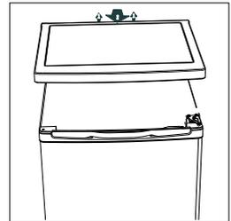
3. Schrauben Sie das obere Scharnier ab und entfernen Sie dann die Tür. Legen Sie die Tür auf eine weiche Unterlage, um Kratzer zu vermeiden.
