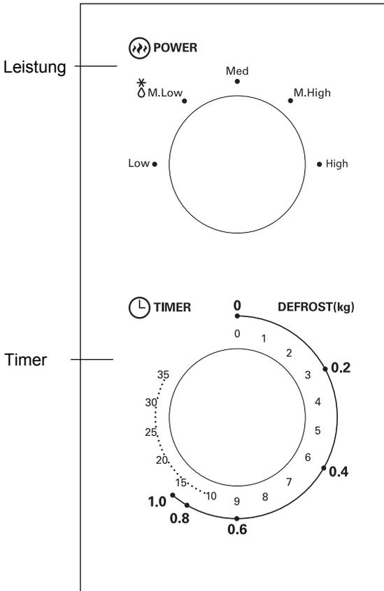
1. Einstellen der Leistungsstufe mit dem Drehknopf für die Leistungsstufe.
