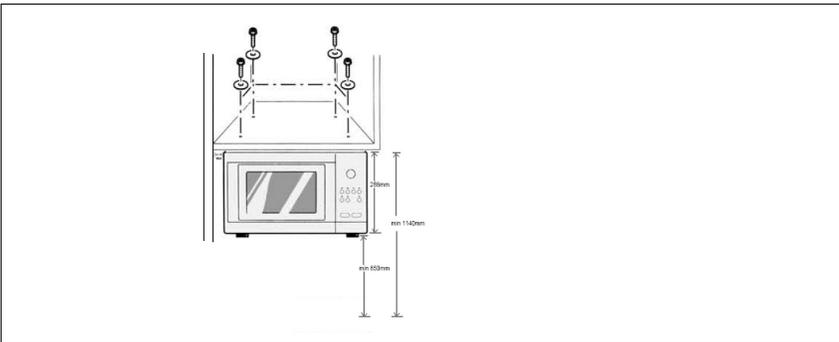
6. Schrauben Sie die Mikrowelle mit 4 Schrauben und Unterlegscheiben am Boden des Schrankes an.
