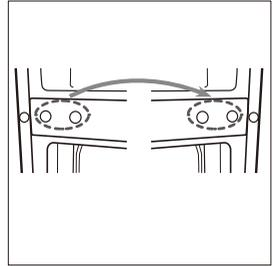
Schrauben Sie das untere Scharnier ab und demontieren Sie die Stellfüsse.
