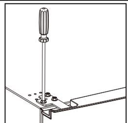
Schliessen Sie die Kabel wieder an und Türschalter. Installieren Sie dann die Scharnierabdeckung.
