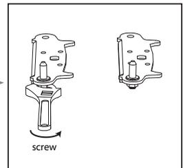
Montieren Sie das untere Scharnier in die Halterung und installieren Sie die beiden Stellfüsse.
