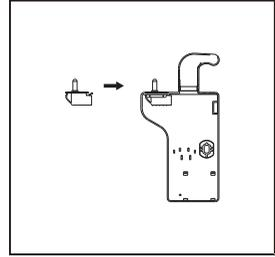
Öffnen Sie die obere Türabdeckung und drehen Sie die Kabelhalterung.
