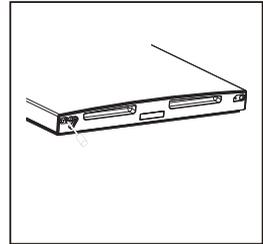
Entfernen Sie die Türdichtungen, drehen Sie diese und installieren Sie sie wieder.
