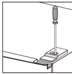
Entferne die obere Türe und schrauben Sie das mittlere Scharnier ab. Entfernen Sie dann die untere Türe.
