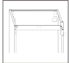
Entfernen Sie den Scharnierstift vom unteren Scharnier, drehen Sie das Scharnier und fügen Sie den Stift wieder ein.
