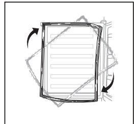
Installieren Sie die untere Türe und das mittlere Scharnier.
